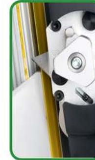
L'outil de coupe à double galet pour le Dibond est monté au dessus de la tête rotative.
