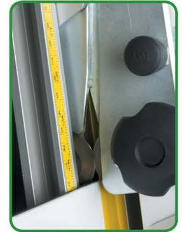
La bande de visée transparente permet de positionner le panneau et visualiser rapidement la ligne de coupe. Cette bande de visée peut être remplacée facilement en cas d'usure.
